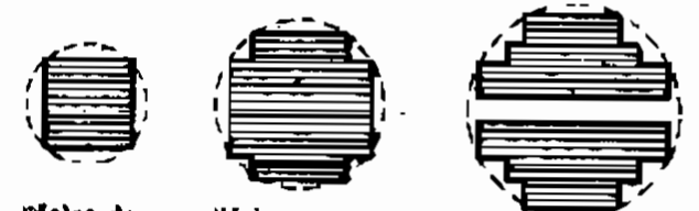
Núcleo en cruz de dos escalones, con un canal de refrigeración
