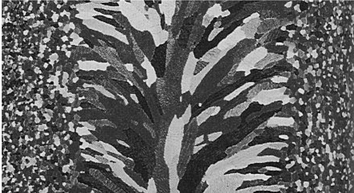
Placa de Nb-Hf-W con cordón de soldadura
