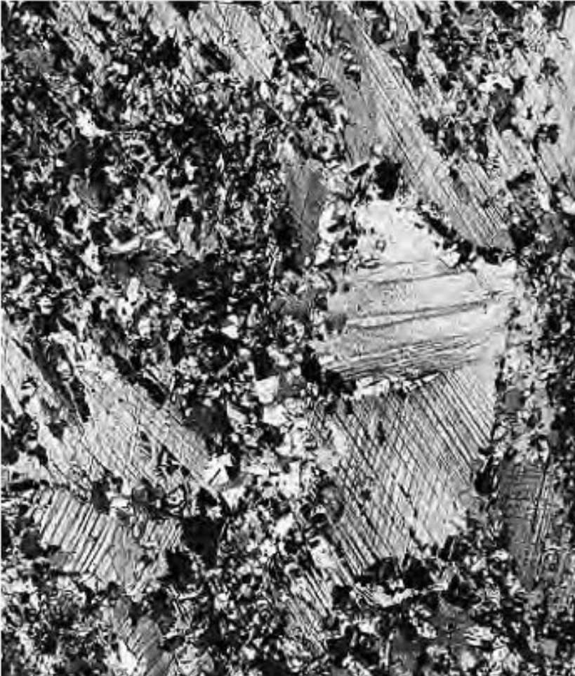
Latón (Cu-Zn) x75: Recristalización parcial, 4s a 580° C
