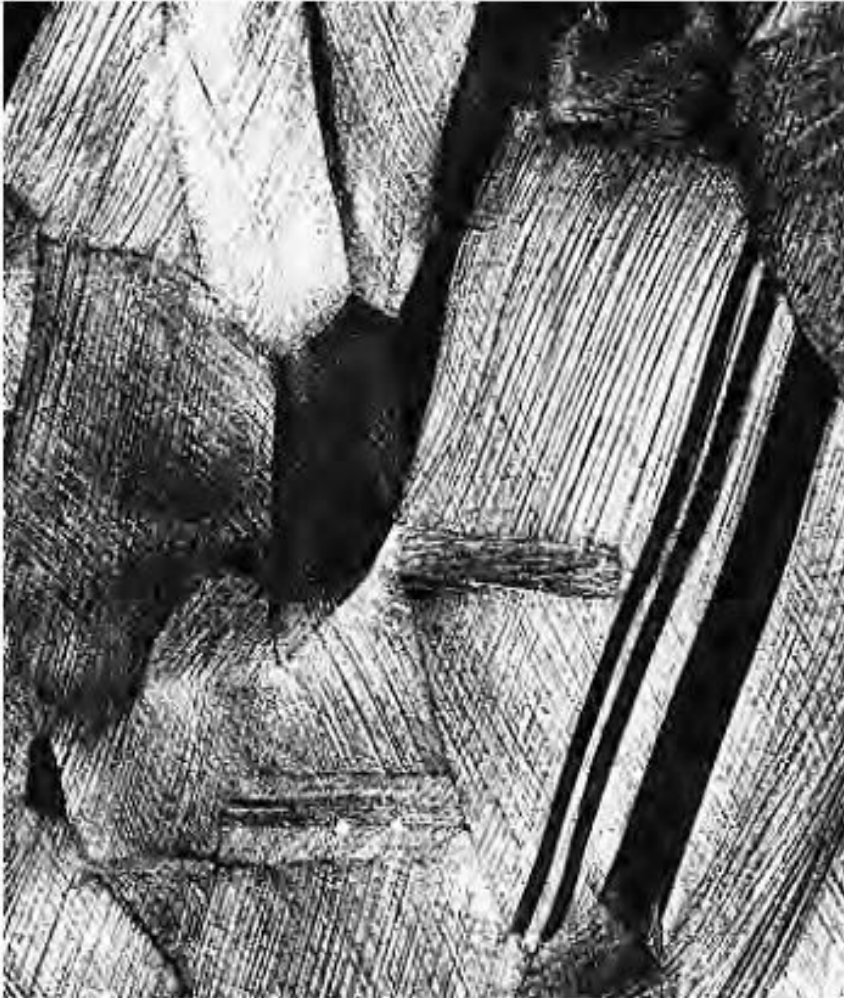
Latón (Cu-Zn) x75: Trabajado en frío (33%CW)
