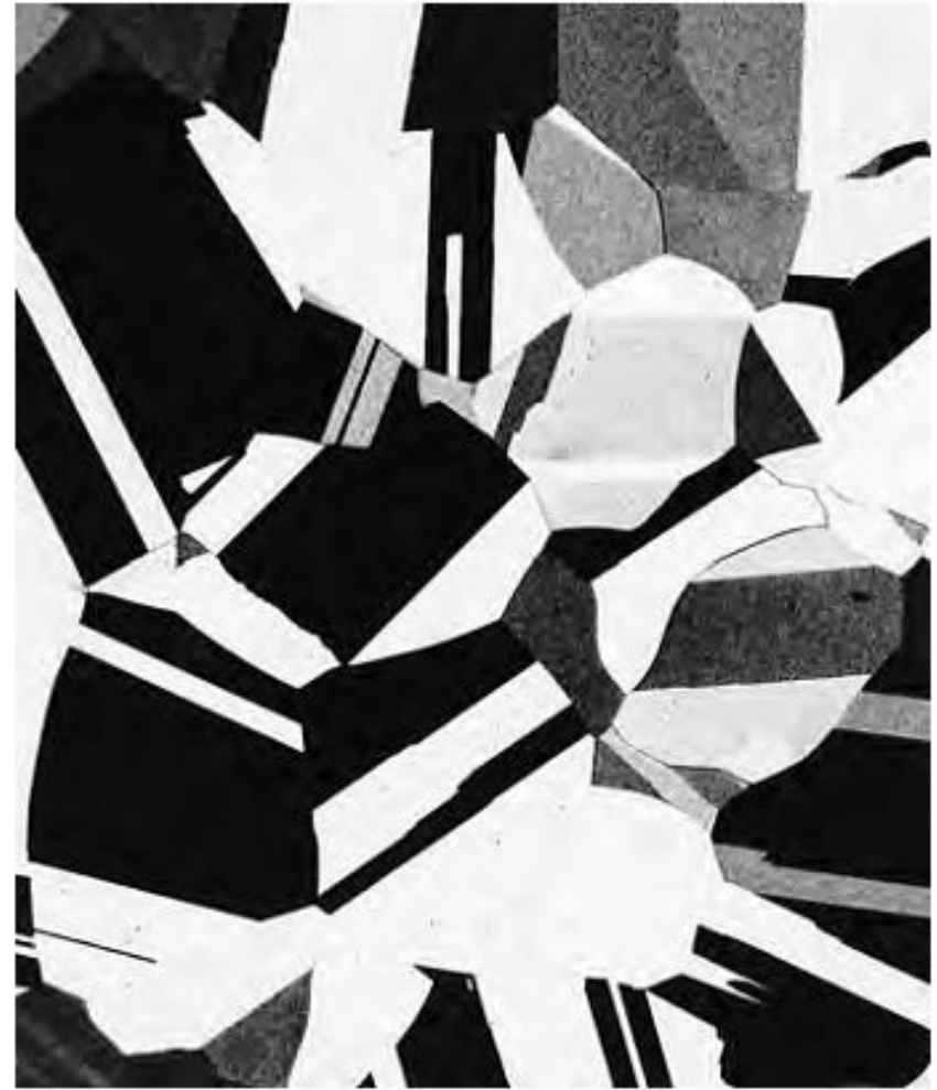
Latón (Cu-Zn) x75: Crecimiento, 10m a 700° C
