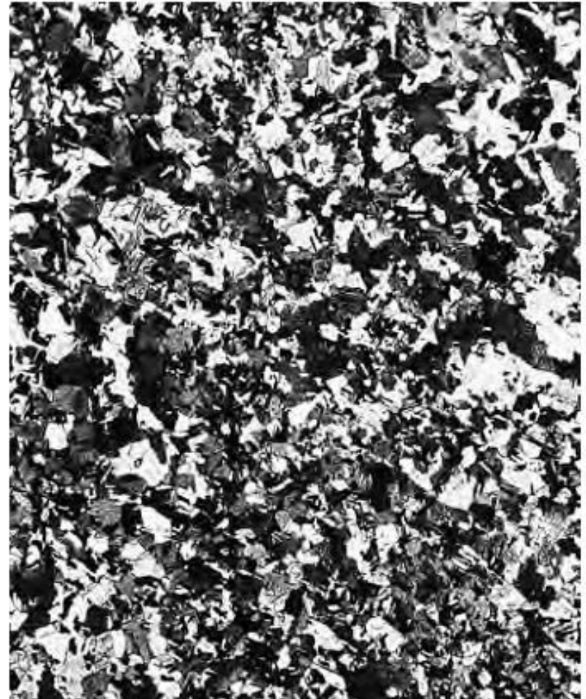
Latón (Cu-Zn) x75: Recristalización total, 8s a 580° C
