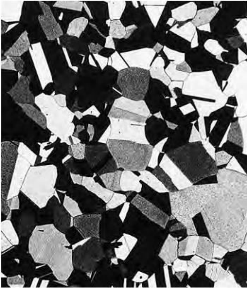
Latón (Cu-Zn) x75: Crecimiento, 15m a 580° C
