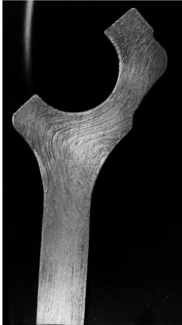
Estructura de fibras y bandas en piezas de acero forjado
