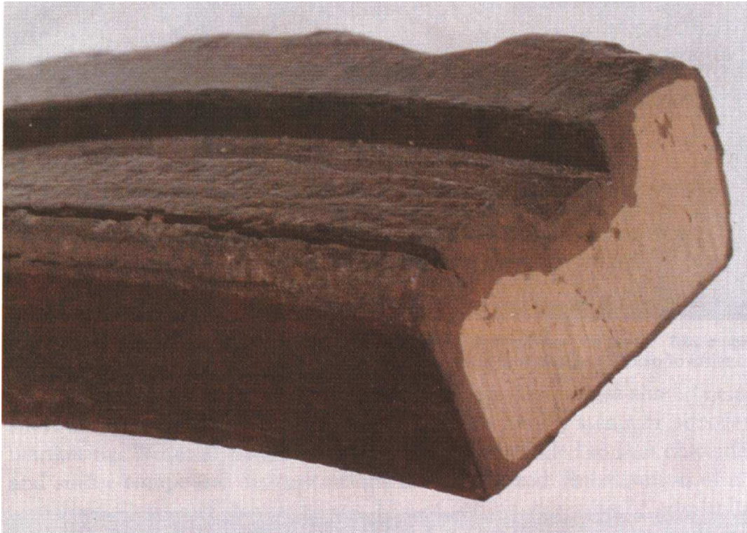
COMPONENTE DE BOMBA PARA CALDERA, DE LATÓN - DEZINCIFICACIÓN LAYER - TYPE (TIPO LÁMINAS)
