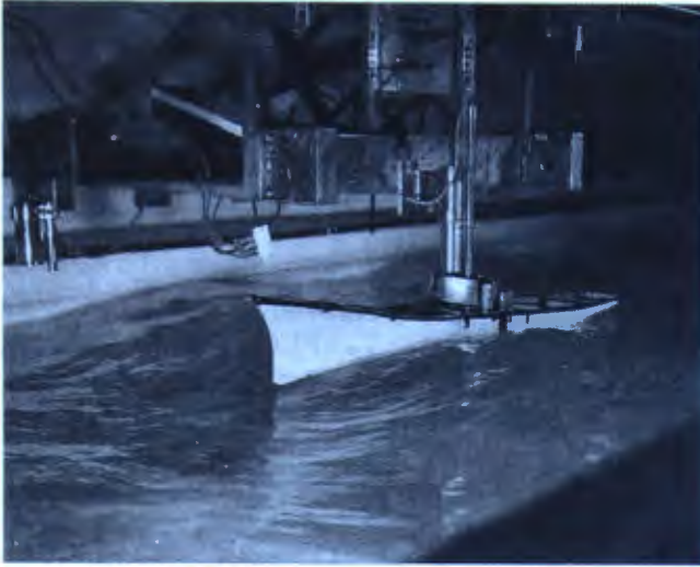
Figura 10.2 El modelo de un barco que se probó en un canal hidrodinámico del MIT, con el cual se simula el movimiento de un barco a través de las olas del mar. La prueba con el modelo se realizó con un número de Froude igual que el del prototipo, pero con un número de Reynolds menor. (Fotografía cortesía del profesor Michael S. Triantafyllou, MIT.)
