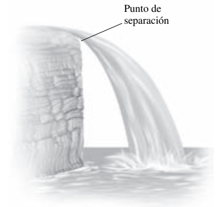
FIGURA 11-13 Separación de flujo en una cascada.
