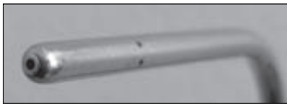
FIGURA 8-54 Acercamiento de una sonda de Pitot estática, que muestra el agujero de presión de estancamiento y dos de los cinco agujeros de presión estática circular.
