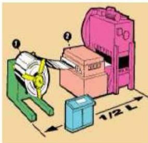
Figura 42. Sistema de alimentación (1 - Devanadora, 2 - Alimentador-Aplanadora)
