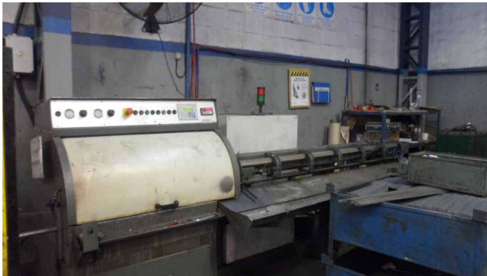
Imagen 7: Devanadora trabajando junto a la enderezadora y cortadora
