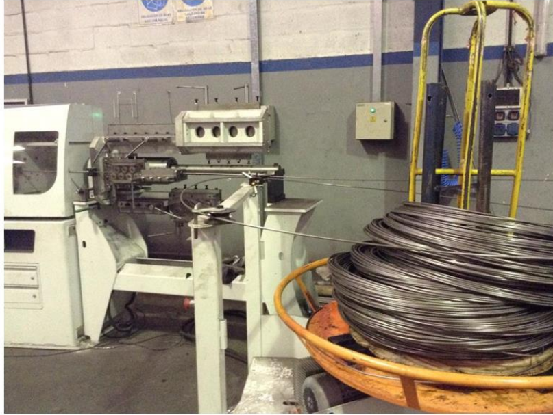
Imagen 6: Devanadora trabajando junto a la enderezadora y cortadora secundaria
