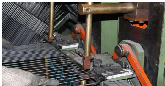
Imagen 17: Soldadura de doble punto
