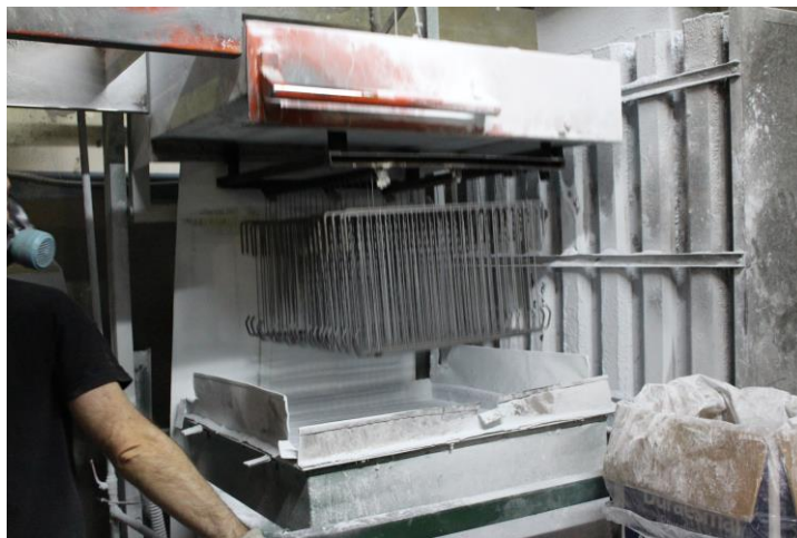
Imagen 20: Rejillas previamente a ser sumergidas
