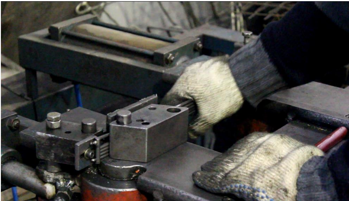
Imagen 11 Dobladora Neumática Manual siendo utilizada
