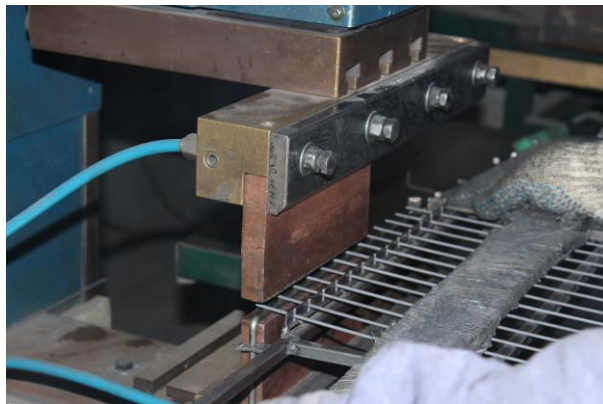
Imagen 13: Soldadura por proyección
