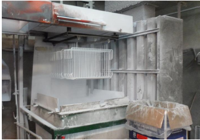
Imagen 21: Rejillas luego de ser pintadas.
