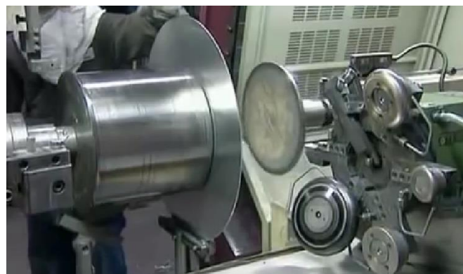
Figura n° 6. Colocación de la lámina en torno
