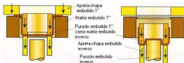
Figura n° 3. Embutido inverso
