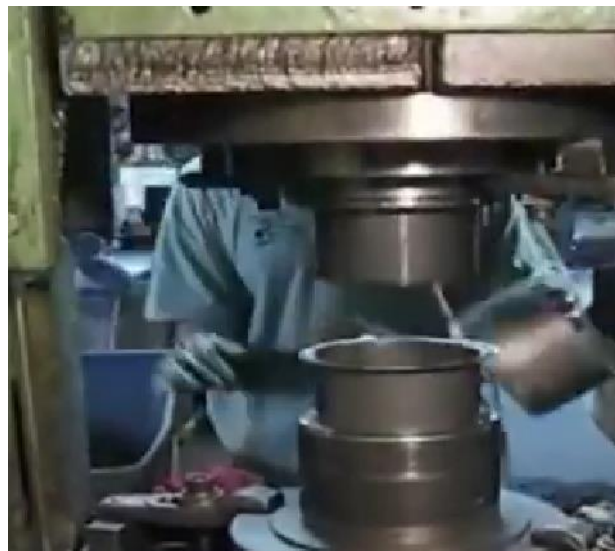
Figura n° 22. Extracción de la olla embutida
