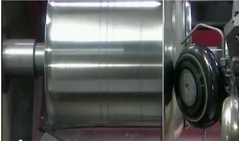
Figura n° 7. Conformación de la olla
